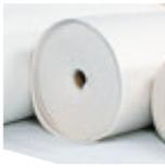
Il s'agit d'un feutre de 550 gr/m<sup>2</sup> en polyester non tissé, avec un traitement fongicide dans la masse. Il est destiné à couvrir les murs sans enduits ou avec des enduits nécessitant un ragréage, ainsi que des structures préfabriquées laissant apparaître des décalages entre les différents éléments.
